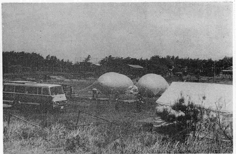
▲飛行船のようなカイツーンを飛ばし、各高度別の大気の乱れ、温度などを調査(公害事前調査、天王中グランドで)
