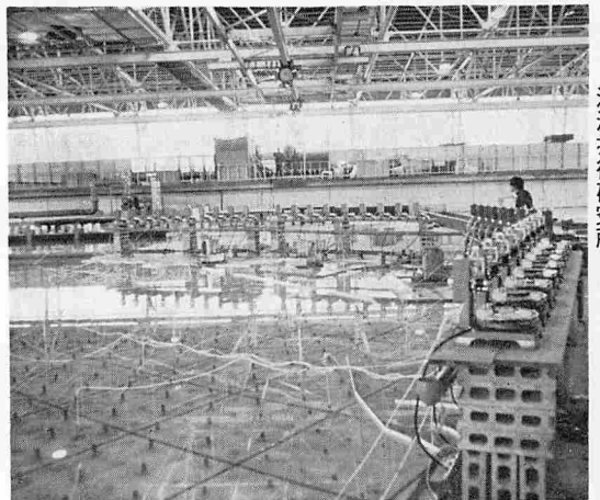
秋田湾の模型がセットされている 港湾技術研究所
